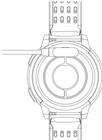
\*Fai attenzione che i due contatti del cavo USB non sono autorizzati a contattare il conduttore contemporaneamente o potrebbe causare un corto circuito
