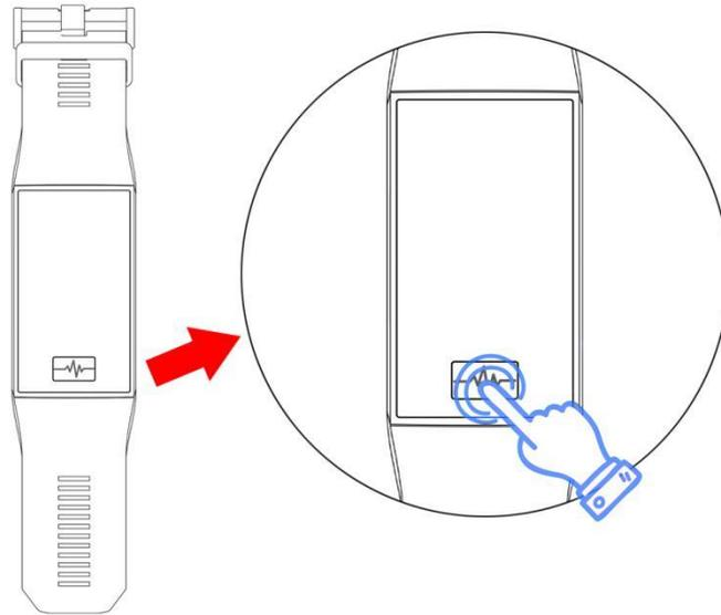
Mantenga presionado el pulsador táctil durante 3 segundos para encender. Haga clic para pasar de una función a otra. Mantenga presionado para acceder a esa función.
